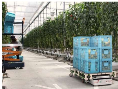
⑤ 無人搬送車を導入し、収穫物の搬送作業の省力化と効率化改善を図る
